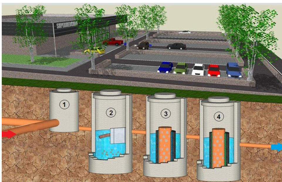
1 - ДОЩОПРИЙМАЛЬНИЙ КОЛОДЯЗЬ; 2 - РЕЗЕРВУАР-ПІСКОЛОВКА; 3 - НАФТОСЕПАРАТОР; 4 - БІОБЛОК
